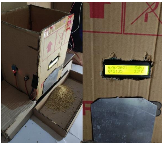
Gambar 8. Hasil Jalan Sensor Suhu DHT11 dan Tampilan LCD
